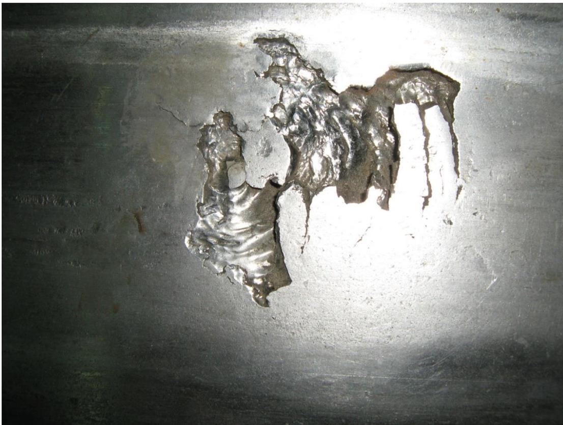
Рисунок 2.3 - Выкрашивание на поверхности катания бандажа
