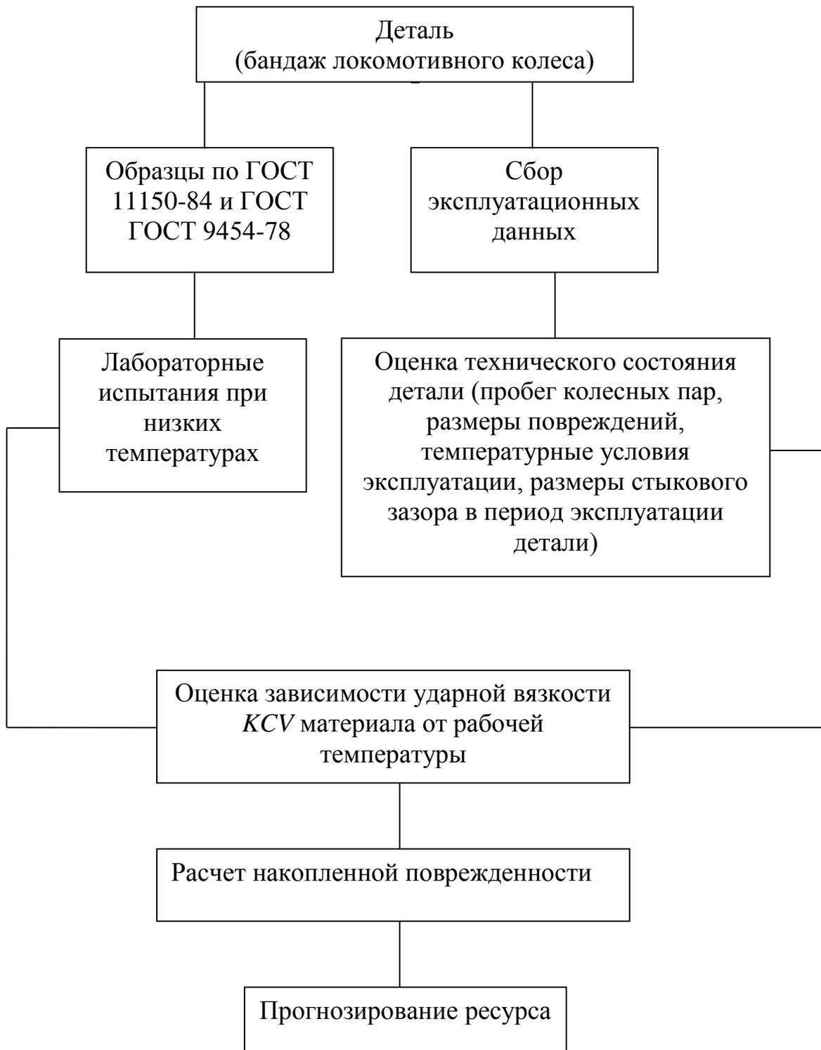
Рисунок 4.2 - Блок - схема определения ресурса бандажа локомотивного колеса.
