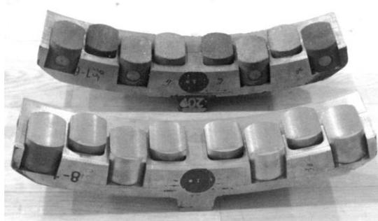
Рис. 2.6. Фото моделей тормозных колодок в сборе
