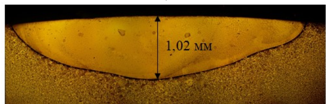
Рисунок 2 – Результаты моделирования процесса плазменного оплавления: а – Модель 3D; б – зависимость глубины упрочнённого слоя от силы сварочного тока; в, д – сопоставление данных модели с реальным экспериментом
