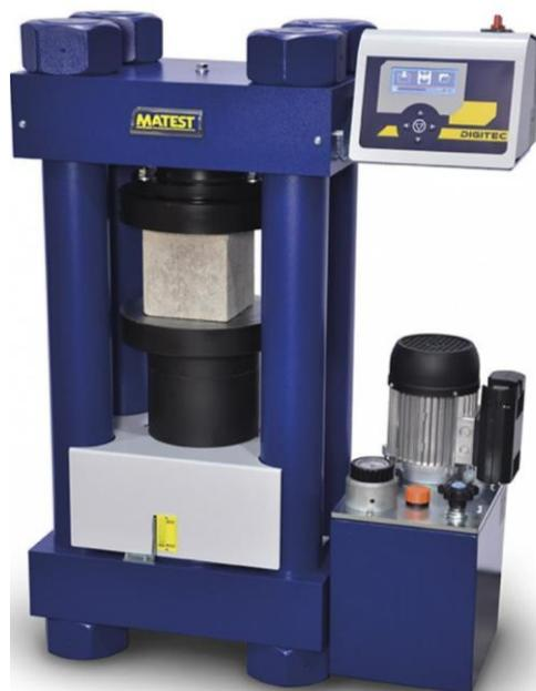
Рисунок 2.2 – Испытательный пресс ТП-1-1500
