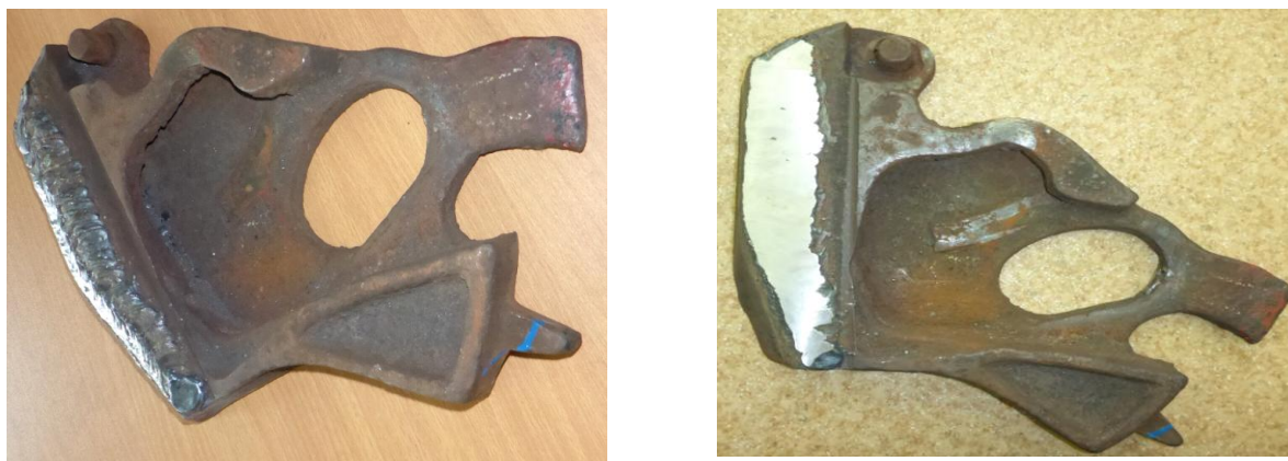
Рис. 15. Восстановленные замки автосцепок разработанными порошковыми проволоками
