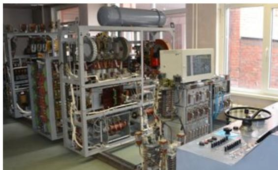
Рисунок 11 – Лабораторный стенд для исследования работы электровоза
