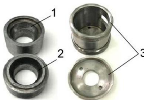
Рисунок 5 – Штамповая оснастка: верхняя (1) и нижняя (2) части матрицы с корпусом (3)
