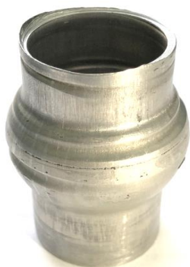
Рисунок 6 – Потеря устойчивости трубчатой заготовки
