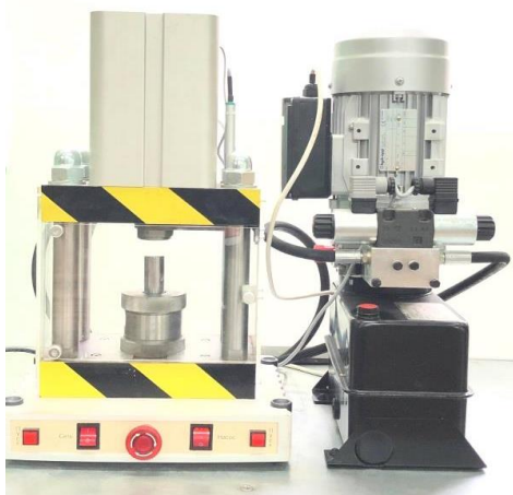
Рисунок 4 – Установка для экспериментального изучения основных видов штамповки
