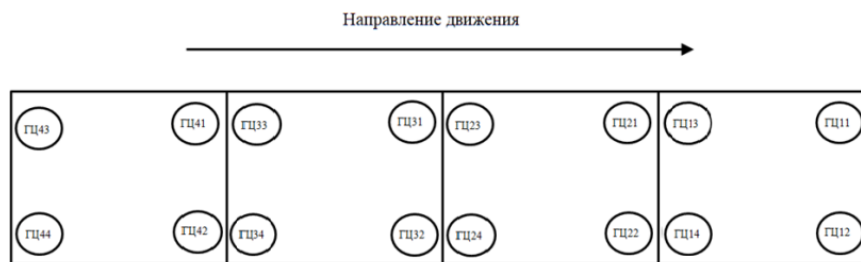
Рисунок 9 – Функциональная схема гидравлической системы трала при виде сверху
