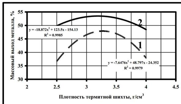
Рисунок 7 – Зависимости массового выхода восстановленного металла от плотности упаковки смесей, уплотненных:
