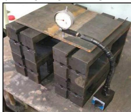
Рисунок 2 – Устройство со стрелочным индикатором КИ
