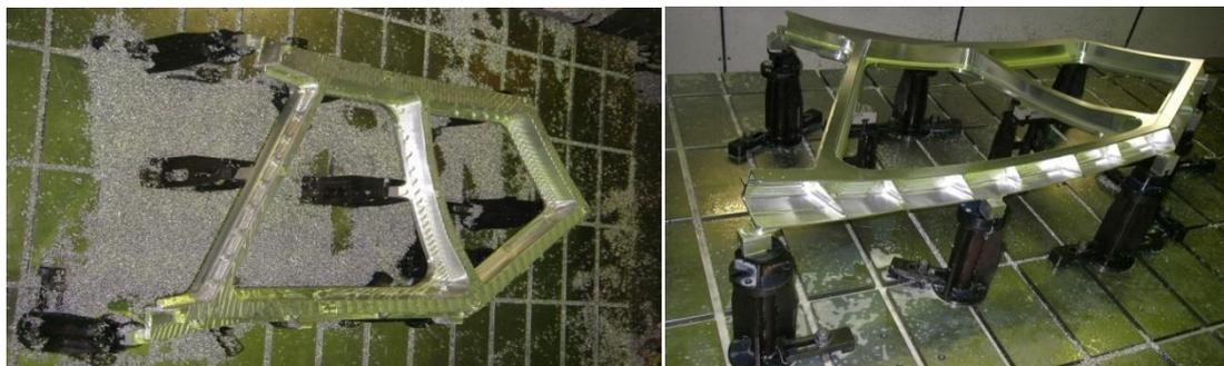
Рисунок 34 – Рама переплета установленная на стойках в ходе обработки.
