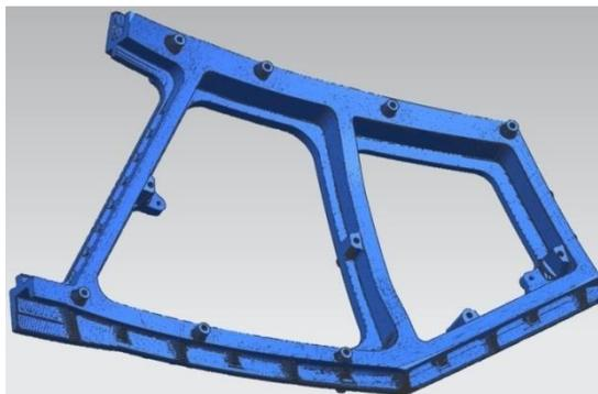
Рисунок 45 – 3D модель заготовки с равномерным припуском 6 мм.
