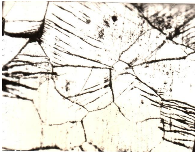
Рис. 3.38. Микроструктура титана ВТ-1-00 после испытаний на усталость при 20° С; ( \times 600 ); \sigma = 160,1 МПа; N = 9,55 \cdot 10^4 циклов; \omega = 46,7 Гц. Деформация изгиба вращающегося образца
