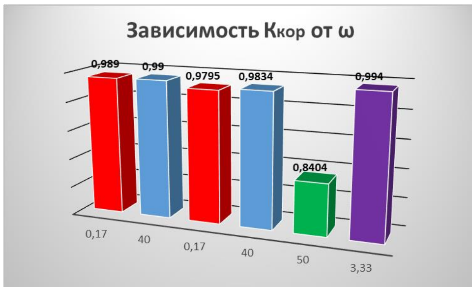
Рис. 4.26. Изменение разброса экспериментальных данных относительно аппроксимирующих линий кривых усталости стали 30ХГСН2А при изменении частотно-скоростных условий нагружения
