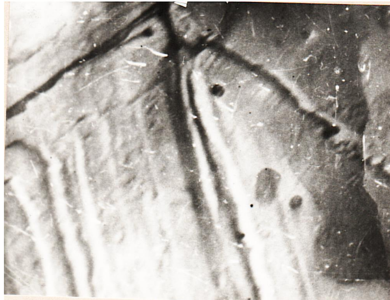
Рис. 3.43. Микроструктура кадмия после циклической нагрузки при 20°C; \times 14400 ; \sigma = 360 \text{ МПа} ; N = 2634 циклов; \omega = 0,033 \text{ Гц}
