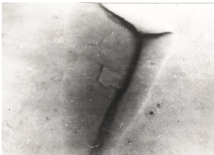
Рис. 1.21. Ямка травления на поверхности монокристалла алюминия (схема на рис. 1.20,б) до его испытания, х 19000
