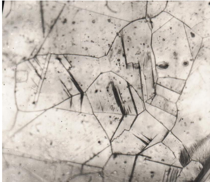
Рис. 3.44. Микроструктура никеля после циклической нагрузки при 20°C; a – х340, \sigma = 122 МПа, N = 10^5 циклов, \omega = 46,7 Гц; б – х340, \sigma = 170 МПа, N = 2 \cdot 10^5 циклов, \omega = 100 Гц
