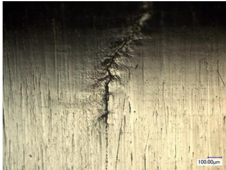
Рис. 2.19. Микроструктуры цилиндрического образца в процессе испытаний на усталость: а – деформационный рельеф;
