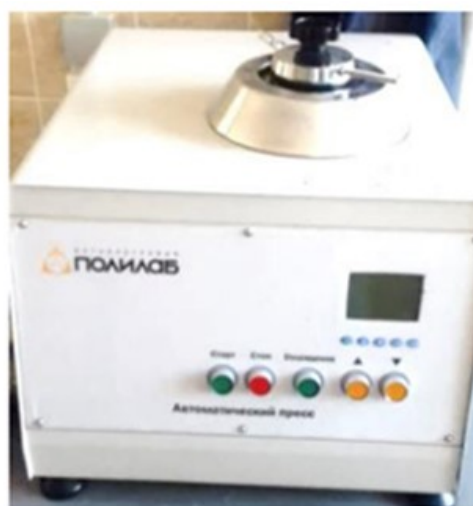
Рисунок 2.11 – Автоматический пресс Полилаб С50А (а) и полуавтоматический шлифовально-полировальный станок (б)
