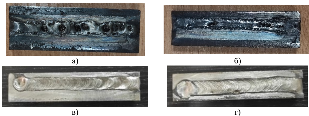
Рисунок 2.4 – Образцы после плазменного оплавления борсодержащей смеси в режиме тока 140А: а – без добавки железа, б – с добавкой 5% Fe, в – с добавкой 10% Fe, д – с добавкой 25% Fe
