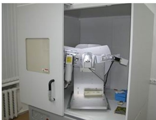
Рисунок 2.13 – Дифрактометр рентгеновский Shimadzu XRD-7000 с системой поликапиллярной оптики
