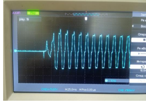
Рисунок 12 – Внешний вид макета ГЧРП с ДР-ОЗТ (а); осциллограммы входного тока в момент подключения физического макета ГЧРП к питающей сети (б)
