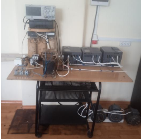
Рисунок 12 – Внешний вид макета ГЧРП с ДР-ОЗТ (а); осциллограммы входного тока в момент подключения физического макета ГЧРП к питающей сети (б)
