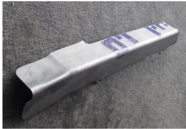
Отформованная деталь из титана без применения подвижного прижима
