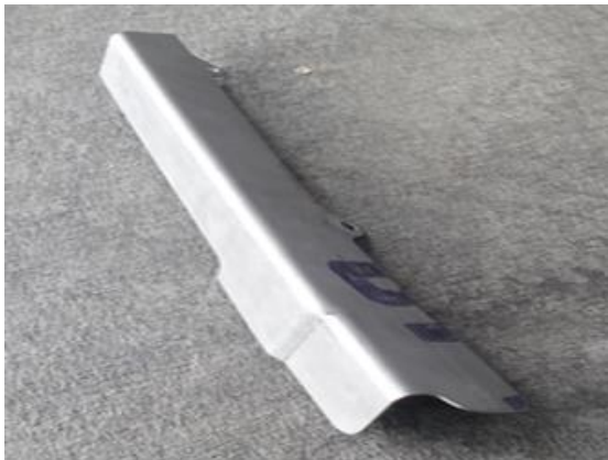
Отформованная деталь из титана с применением подвижного прижима
