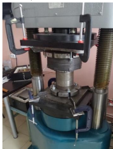
Рисунок 11 – Блок эластоформования на прессе ИП-1250
