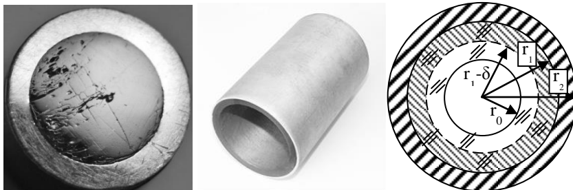
Рис. 1. Стеклометаллокомпозит (стержень, труба) и расчетные области
