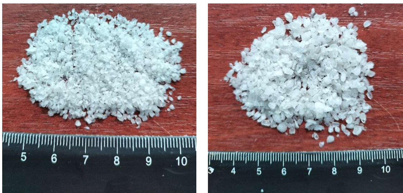
Рисунок 2.3. Внешний вид фракций парафина марки Т1. а – фракция 0,63 мм; б – фракция 2,5 мм.
