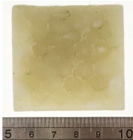
Рисунок 4.4. Внешний вид прессовки с пористостью 10 %, полученной уплотнением шаровидных элементов, выполненных из воскообразного модельного материала
