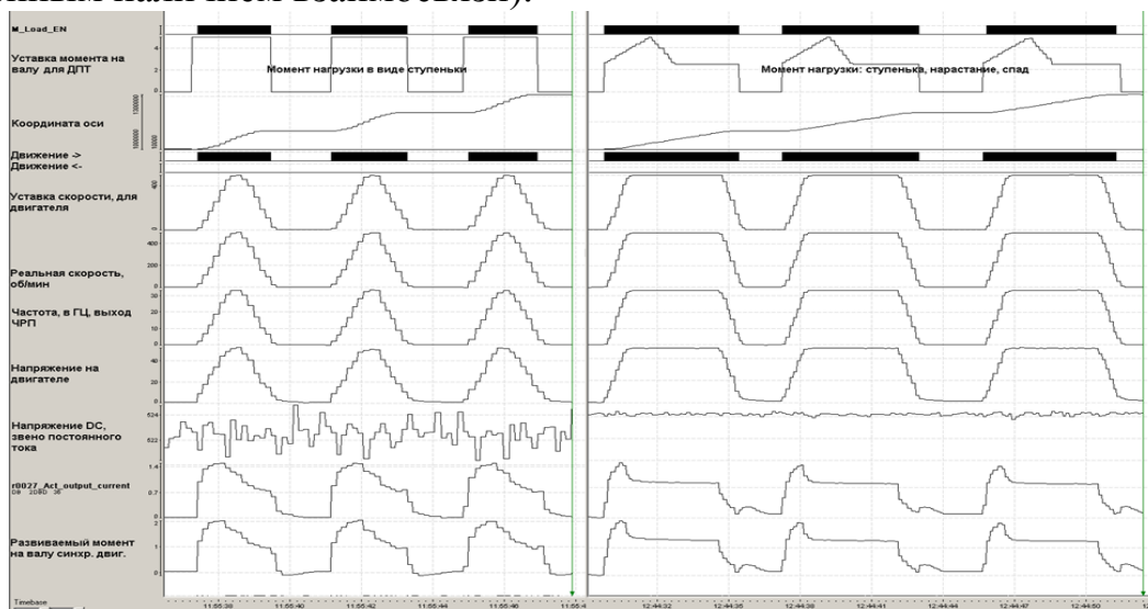
Рисунок 12 – Осциллограммы динамических кривых основных параметров системы управления в классическом варианте при отработке системой позиционирования нагрузки постоянного вида и комбинированного вида нагрузки
