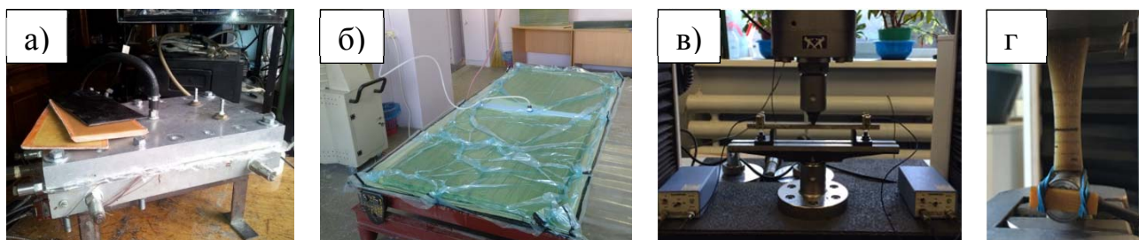
Рисунок 1 – Изготовление и испытание образцов: а – лабораторный автоклав; б – метод вакуумной инфузии; в – испытание на статический изгиб; г – испытание на статическое растяжение
