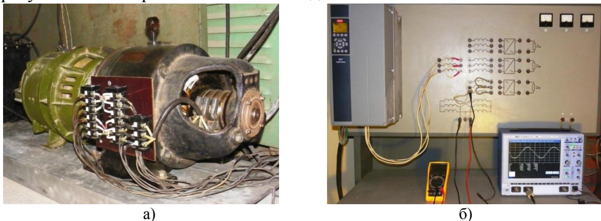
Рис.6. Экспериментальная установка: а) СДМГ на платформе с приводным двигателем, б) универсальный стенд с измерительными приборами.
