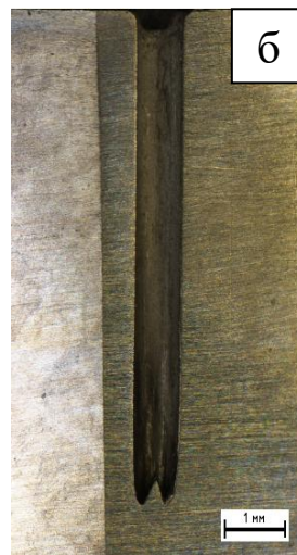
Рисунок 13 – Профилограмма поверхности (а) и фотография продольного сечения отверстия (б), сформированного электроэрозионно – электрохимической прошивкой в нержавеющей стали 12X18H10T катодом – инструментом 0,39/0,64 мм с изолированной боковой поверхностью в 5 % \text{NaNO}_3 на подаче S = 2,05 мм/мин при U = 10 В; P = 0,8 МПа; U_{\text{имп}} = 250 В, C_2 = 47 нФ; f = 25 кГц
