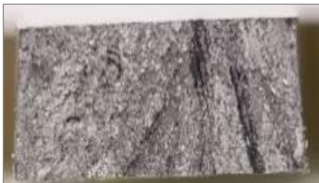
Рис. 11. Излом образцов из исследуемого сплава при растяжении
