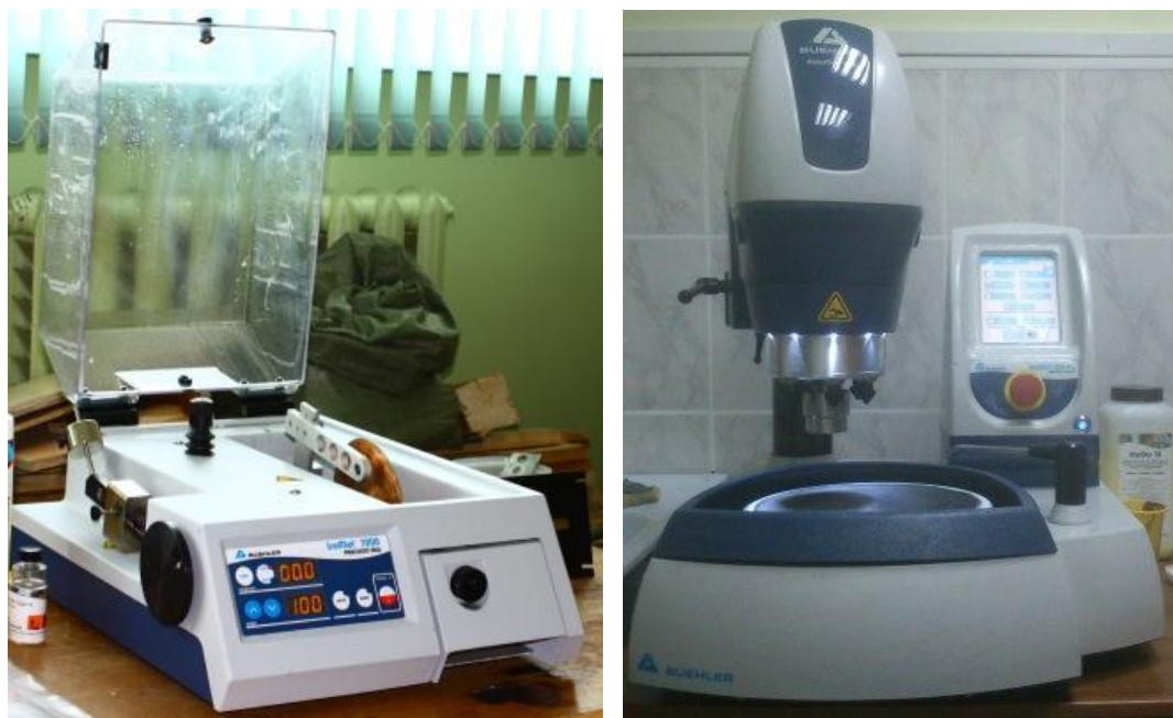
Рисунок 2.5 – Оборудование для выполнения резки (а) и шлифовки/полировки (б) образцов
