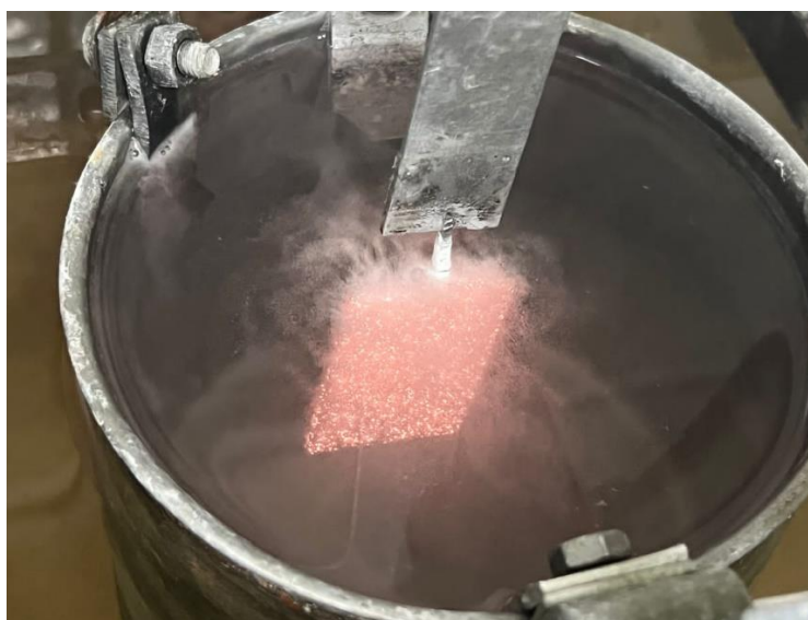
Рисунок 2.2 – Фотография ванны в процессе МДО образца сплава 7075
