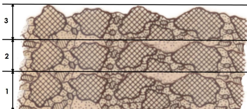
Рис. 3.3 Структура трехслойной КОФ после прокаливания
