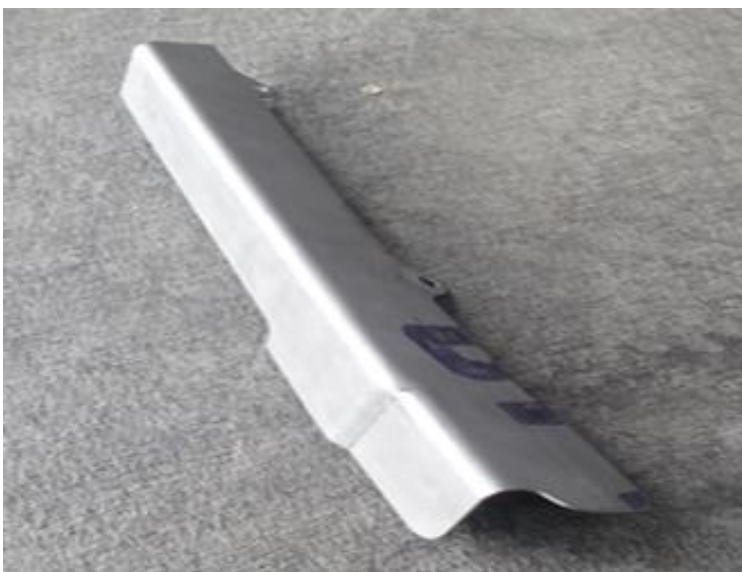
Рисунок 4.72 – Отформованная деталь из титана с применением подвижного прижима
