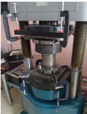
Рисунок 4.11 – Вся конструкция для формообразования деталей эластичной средой в сборе
