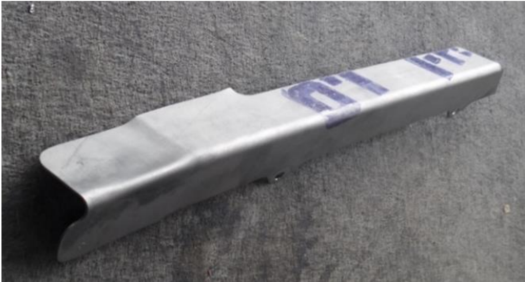
Рисунок 4.73 – Отформованная деталь из титана без применения подвижного прижима
