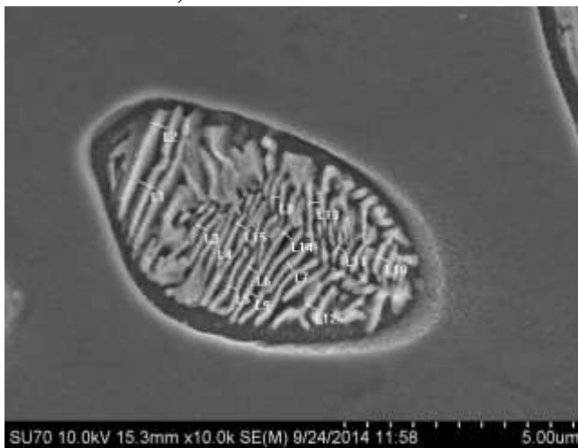
Рисунок 17 - Микроструктура хромистого чугуна и степень дисперсности продуктов распада переохлажденного аустенита от величины добавок \Phi СМГ7 внутри карбидной эвтектики (x10000)
