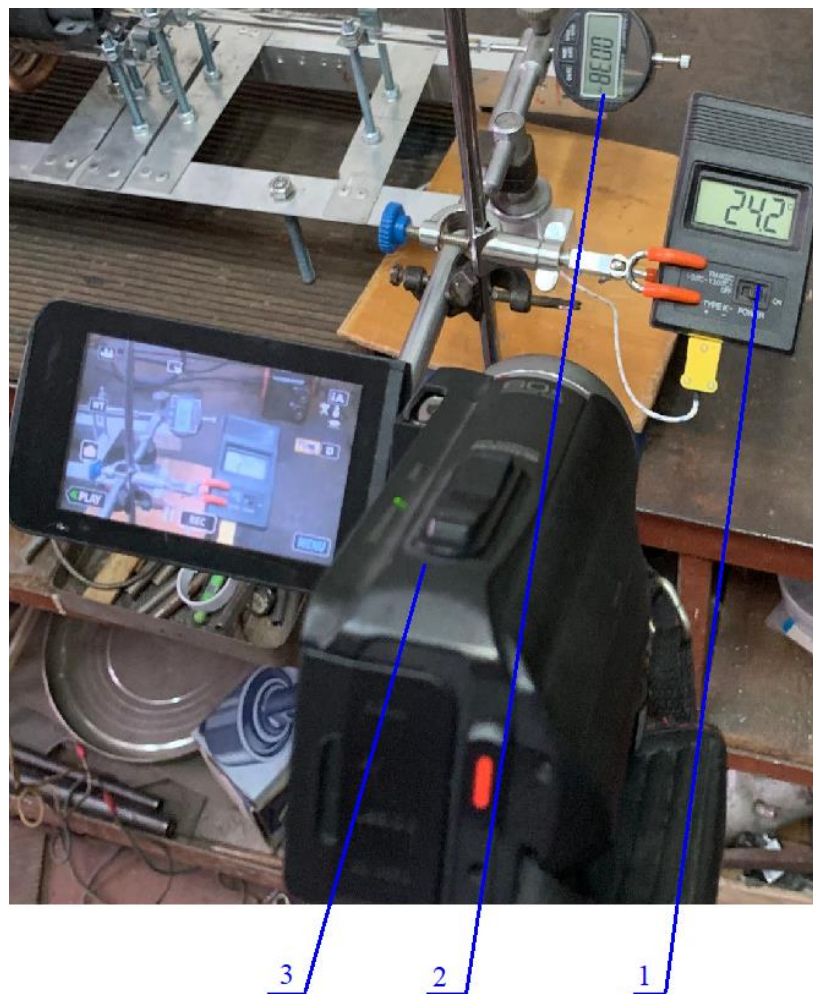
Рисунок 3.10 Измерительная станция: 1-термопара, 2-цифровой микрометр, 3-видеокамера, 2-цифровой микрометр, 3-видеокамера
