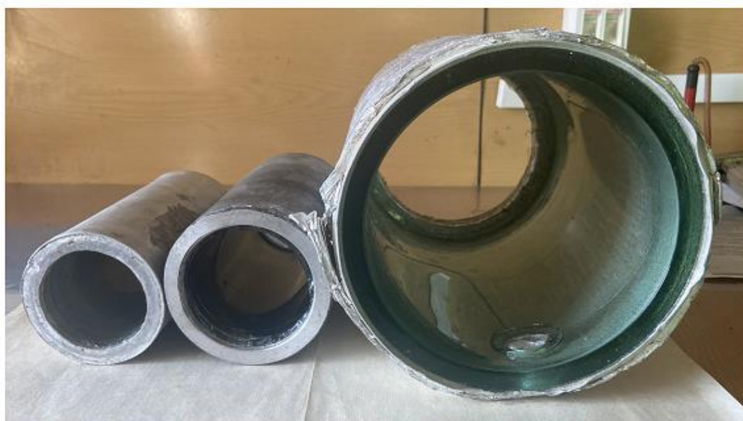
Рисунок 1.1 Фотографии экспериментальных образцов двухслойного и трехслойного цилиндрического СМК, изготовленные методом центробежного литья (сплав алюминия-стекло-сплав алюминия)[105, 106, 126, 171]
