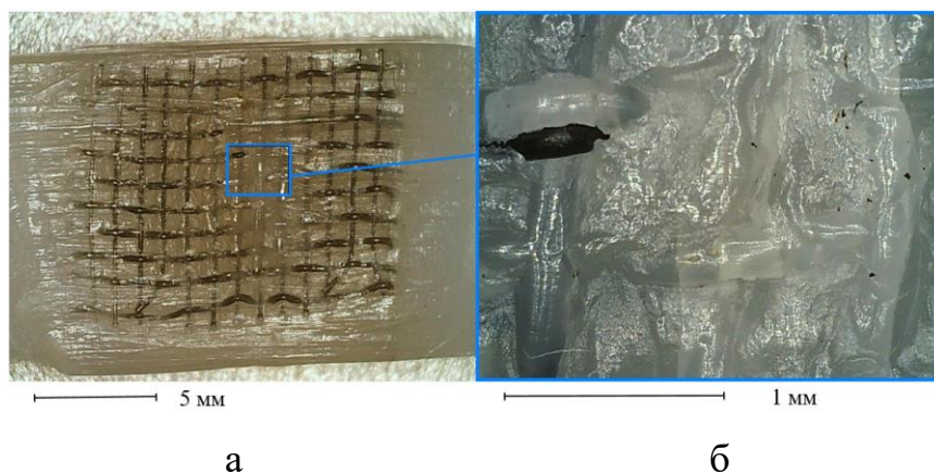
Рисунок 3 – Макрофотография образца, соединенного при температуре 270 °С (а) и его увеличенная часть (б).
