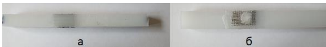
Рисунок 2 – Макрофотографии соединенных образцов: а – при температурах 190, 210, 230, 250 °С; б – при 270 °С
