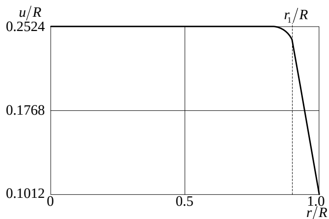
Рис. 11. Распределение перемещений точек материала и смазки в конечный момент времени
