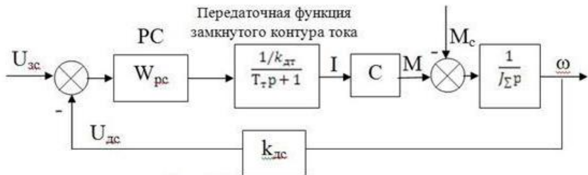
PC – регулятор скорости; M – электромагнитный вращающий момент двигателя; M с – статический момент нагрузки; Рисунок 1.2 – Структурная схема контура скорости
