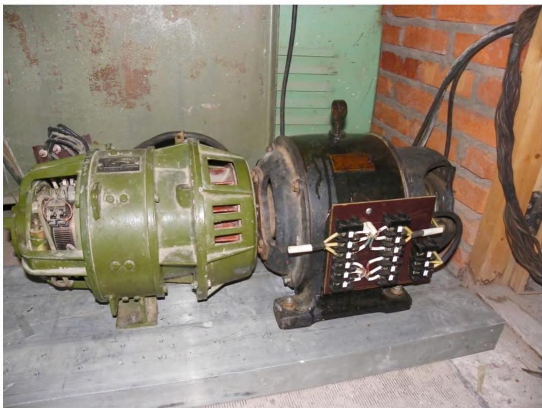
Рис. 4.4. СДМГ на платформе с приводным двигателем.
