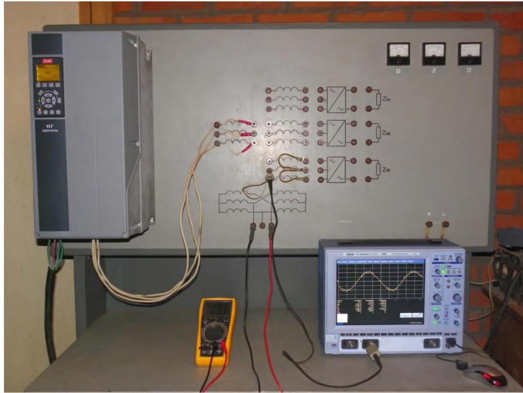
Рис. 4.5. Универсальный стенд с измерительными приборами.
