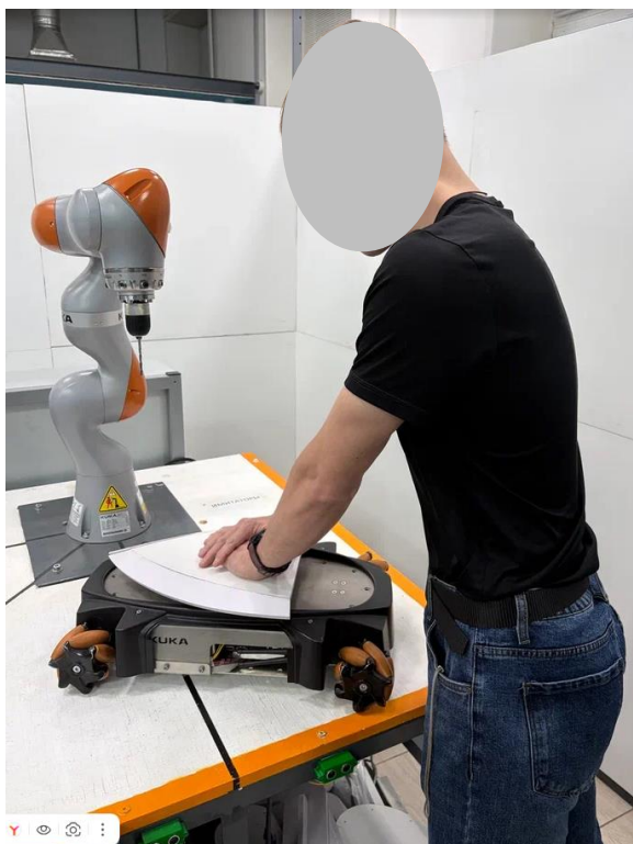
Рисунок 7.7 – Рабочая зона коллаборативного роботизированного технологического процесса механообработки (с участием оператора)
