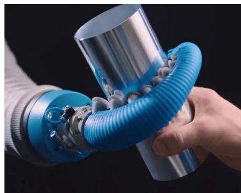
Рисунок 1.2 – Рабочий орган КР: а – шпиндель; б – трехпальцевый захват с силиконовыми пальцами; в – бионический захват «кисть»; г – металлический двухпальцевый захват; д – вакуумный захват; е – бионический универсальный захват
