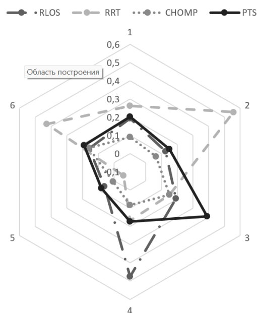
Рисунок 5.31 – Приоритетность выбора алгоритма в зависимости от установленного критерия, 1 – акценты отсутствуют; 2 – энергосбережение при исполнении движения; 3 – минимизация времени расчета при максимизации вероятности достижения результата; 4 – максимизация плавности движения; 5 – минимизация времени при получении неудовлетворительного решения; 6 – минимизация увеличения длины траектории и вероятность разрешения коллизии в один проход
