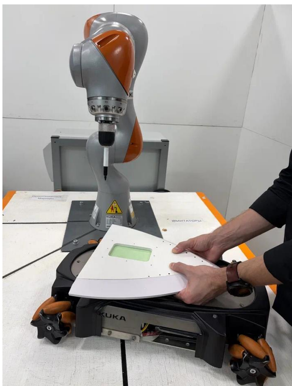
Рисунок 7.8 – Рабочая зона КРТП (с участием оператора) нанесения полимерных композиционных материалов по периметру люка (установлен имитатор автоматического дозатора герметизирующих материалов)
