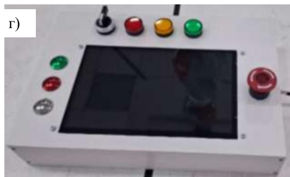
Рисунок 6.6 – Оборудование средств измерения и интерфейсов ввода/вывода; а – планшетный компьютер Samsung Galaxy Tab S9 FE+, реализующий интерфейс ввода/вывода; б – устройство измерения положения точки в ОП; в – пульт оператора и система ультразвуковых датчиков расстояния; г – пульт выбора режима и ввода экстренных команд для КР
