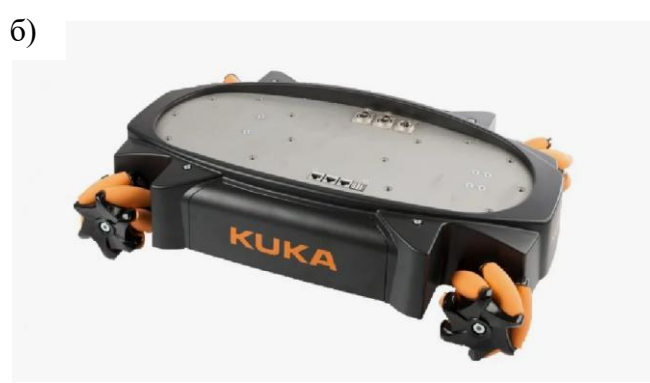
Рисунок 6.5 – Позиционирующее оборудование; а – позиционер KUKA md250; б – мобильный робот KUKA youBot
