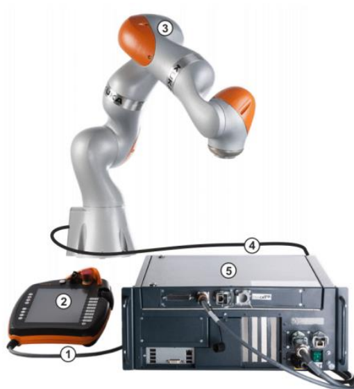
Рисунок 6.2 – Внешний вид оборудования робота KUKA LBR IIWA7 R800: 1 – соединительный кабель к пульта оператора; 2 – пульт оператора (панель управления KUKA SmartPad); 3 – манипулятор; 4 – соединительный кабель к контроллеру КР; 5) контроллер КР ( KUKA Sunrise Cabinet)
