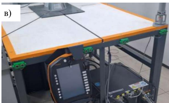
Рисунок 6.6 – Оборудование средств измерения и интерфейсов ввода/вывода; а – планшетный компьютер Samsung Galaxy Tab S9 FE+, реализующий интерфейс ввода/вывода; б – устройство измерения положения точки в ОП; в – пульт оператора и система ультразвуковых датчиков расстояния; г – пульт выбора режима и ввода экстренных команд для КР
