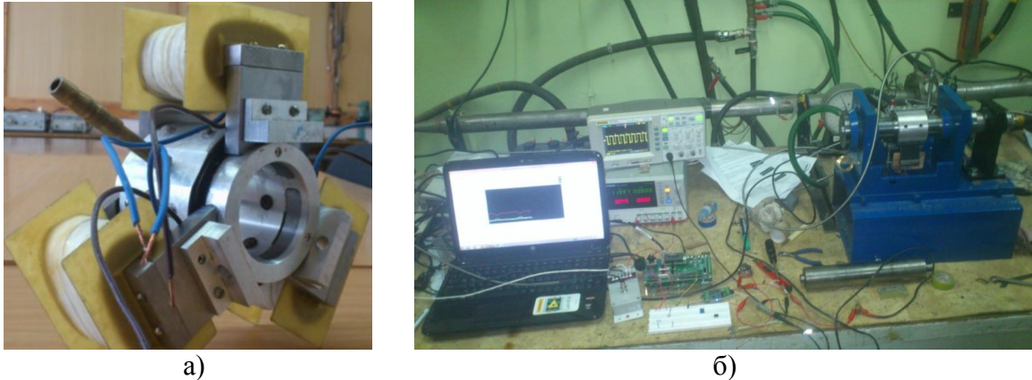
Рис. 10. Опытный образец ГМО (а) и усовершенствованный экспериментальный стенд (б)
