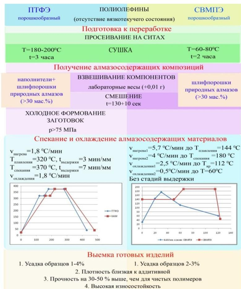
Рисунок 2. Технологические этапы получения алмазосодержащих композитов на основе ПТФЭ и СВМПЭ
