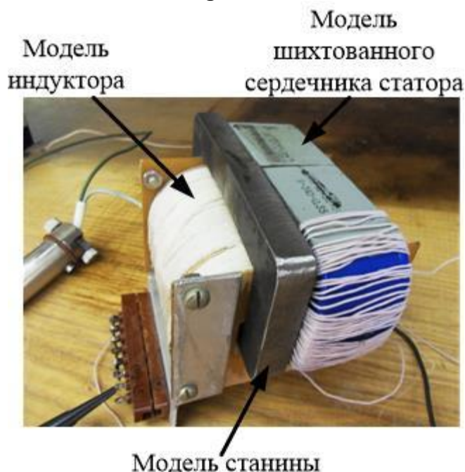
Рисунок 6 – Физическая модель статора
