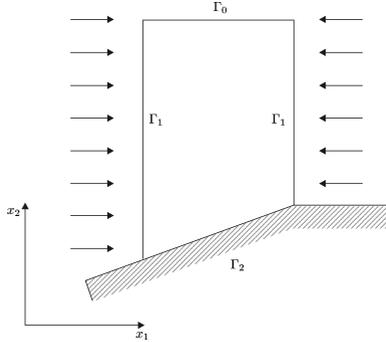
Рис. 1 — Контакт между упругим телом и абсолютно твёрдой опорой
