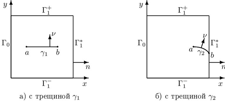
Рис. 3 — Упругое тело  $\Omega$  с трещиной
