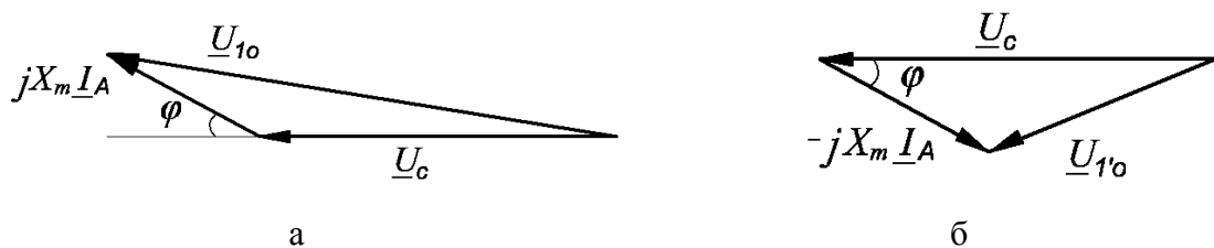
Рисунок 3.11 – Векторные диаграммы напряжений на входе выпрямителя VD1 (а) и VD2 (б)
