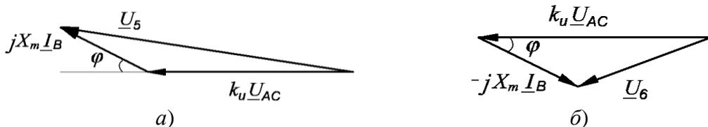
Рисунок 2 – Векторные диаграммы напряжений однофазного ИПАТ: а) – на входе выпрямителя VD1; б) – на входе выпрямителя VD2
